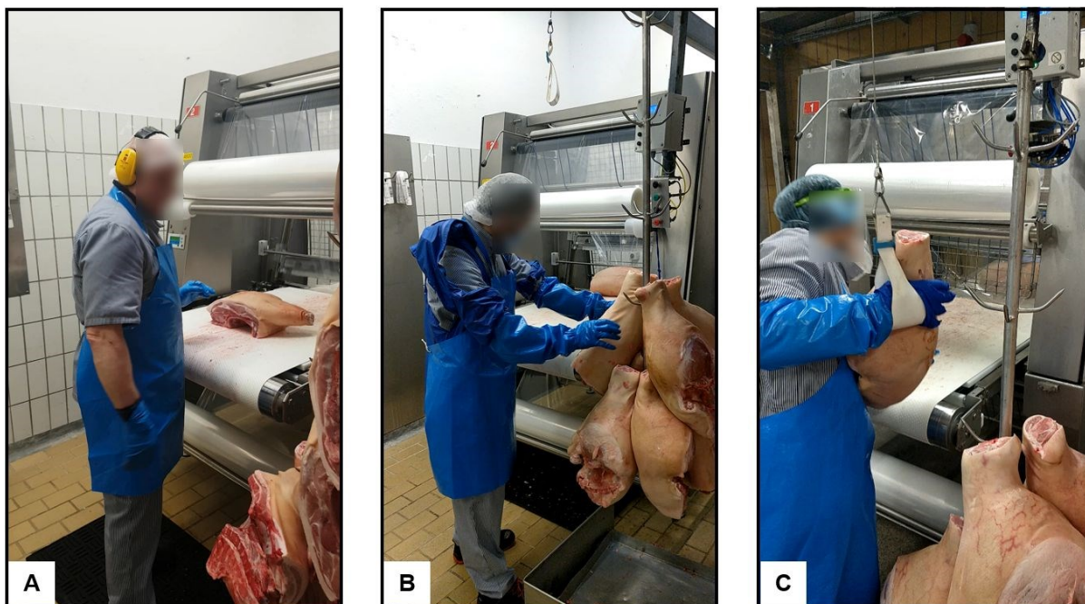
Figur 3. Billederne viser arbejdsopgaven med de tre undersøgte scenarier. [A]: Uden nogen form for hjælpemiddel. [B] Med hjælp fra exoskelettet, pakket ind i dertilhørende cover [C]: Med hjælp fra løftehandsken der hænger fra loftet.
