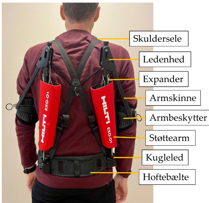
Figur 6. Hilti EXO-01 exoskelet. Billede fra Hilti's manual.
