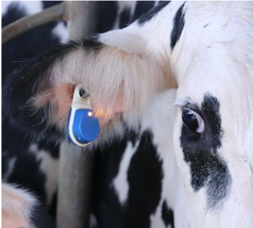
Sensehub/Allflex Flex V2. Udvidet batterilevetid og LED indikator integreret i øremærke. (Kilde: Allflex)
