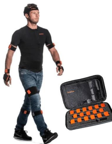
Figur 1: Xsens Awinda-bevægelsesanalyse bestående af 17 bærbare inertielle sensorer, som placeres på udvalgte kropssegmenter. Systemet er trådløst og transportabelt og egner sig derfor til ergonomiske målinger i reelle arbejdsmiljø-kontekster.
