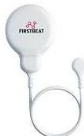
Figur 3: Bærbar Bodyguard 2-sensor anvendt til måling af puls og hjerterytmevariation som supplement til den ergonomiske bevægelsesanalyse.
