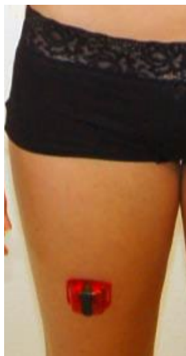
Figur 2: Viser påsat accelerometer til måling af kroppsstillinger og –bevægelser.
