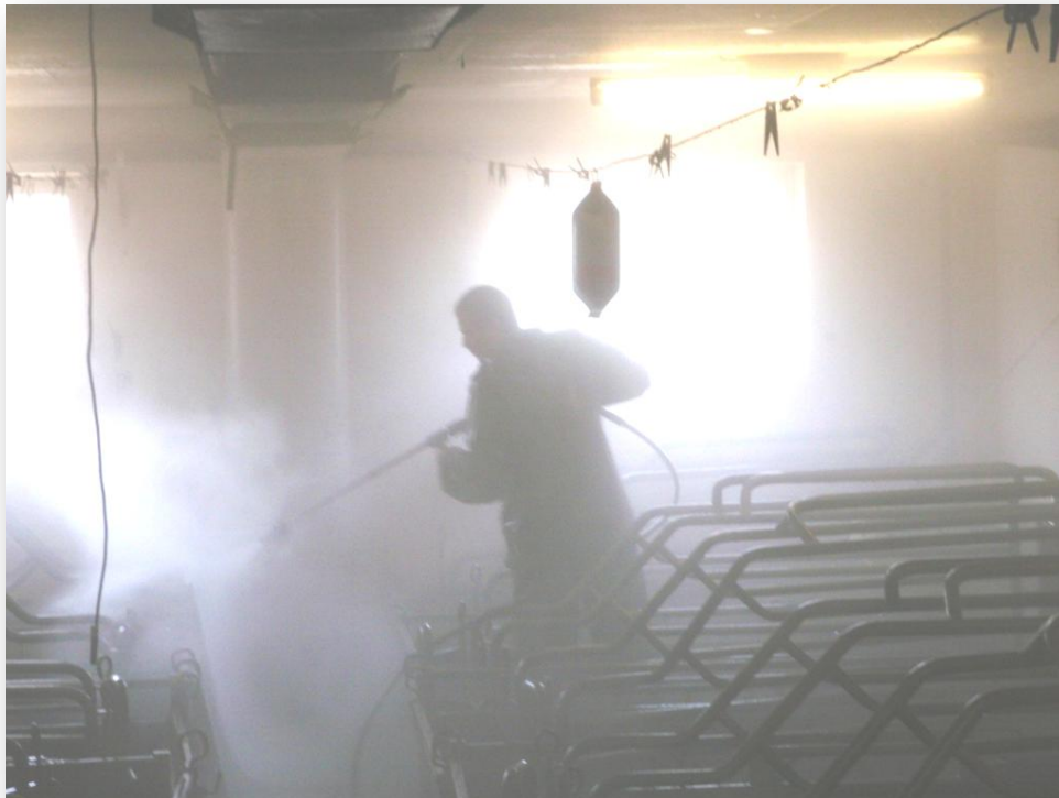
Figur 8. Vask med højtryk frigør støvpartikler fra overflader og gør dem luftbårne igen.
