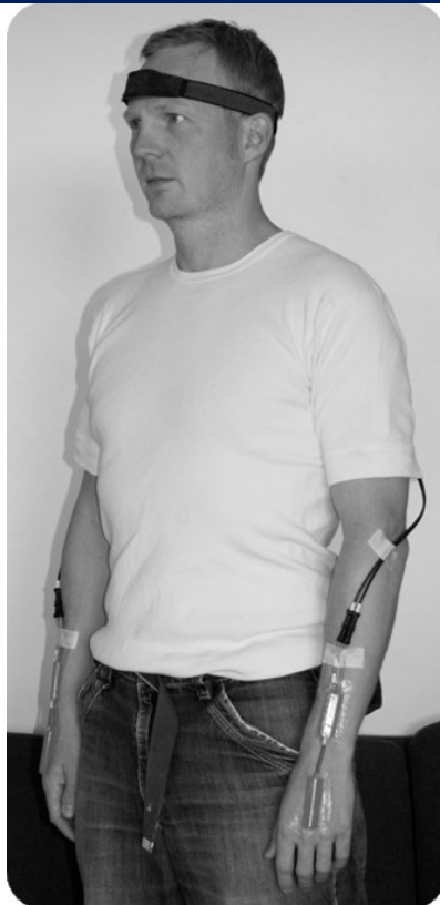
Figur 4. Til venstre: Goniometre til måling af fleksion/ekstension og lateral/medial deviation monteret på begge håndled. Til højre: inklinometre til måling af bevægelseslag for overarme og hoved.
