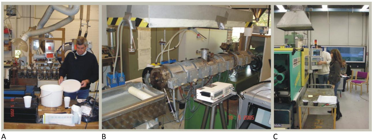
Figur 12. A) Inspektion af blandet granulat og pulver. B) Twin-screw ekstruder med emfang over systemets skorsten og kølekar til venstre i billedet. I forgrunden ses GRIMM OPC; desuden ses små blå pumper forbundet til prøvetagere til opsamling af VOC og SVOC. C) Sprøjtstøbemaskine
