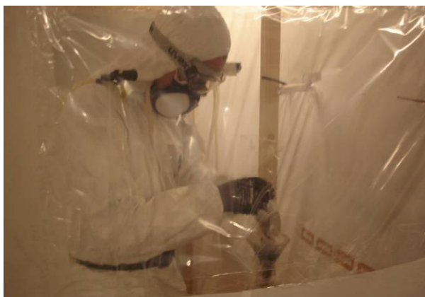
Figur 14. Til venstre ses skitse af "arbejdsteltet" til udportionering af kulstofnanorør og med indikation af målingernes placering. Til højre ses fotografiet af operatør er taget gennem plastvindue. Operatøren er iført værnemidler og i gang med at overføre CNT til blue-cap flasker gennem en tragt.
