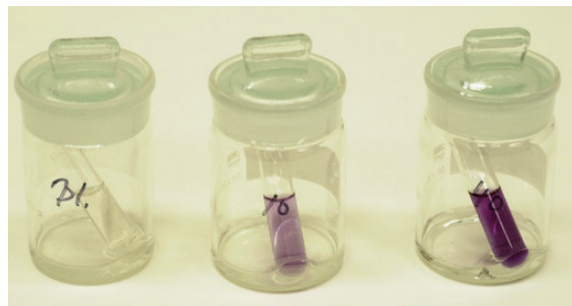
Figur 5: Resultat af en chromotropsyre-test. Til venstre ses en negativ formaldehydtest, i midten en svagt positiv og til højre en stærkt positiv (77).
