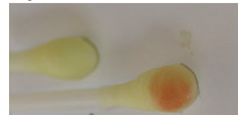
Figur 3: Viser en negativ (venstre) og en positiv (højre) koboltspot-test (78).
