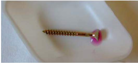
Figur 4: Billedet viser en positiv krom(VI)-spot-test. Dette viser sig ved et farveskift fra klar til rosa. Ved farveskiftet påvises det, at genstanden frigiver krom(VI) (79).
